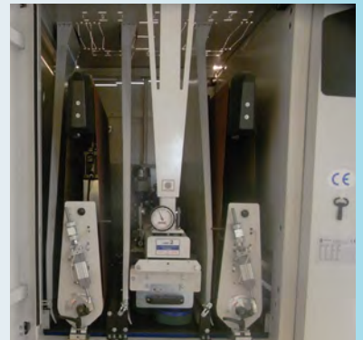
2 Belt units + 1 top brush unit 2 Schleifband Gruppe + 1 Tellerbürsten Gruppe
