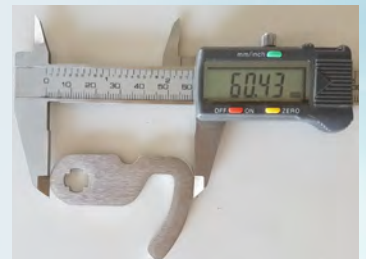
Small piece 60mm processed on table with vacuum system Kleines stück 60mm auf vaku- umtisch verarbeitet
