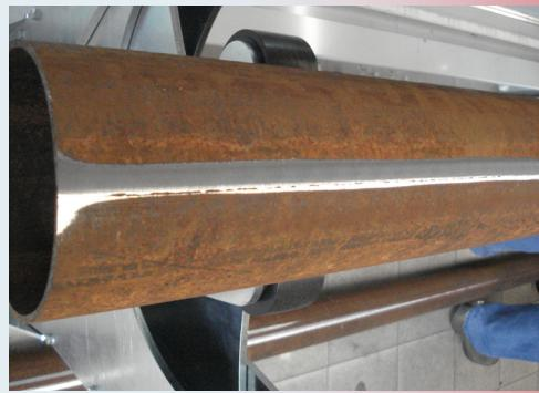
Macchina speciale a due teste abrasive progettata per la rimozione dei cordoni di saldatura di tubi con diametro da 50 a 300.
