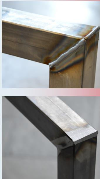
Macchina smerigliatrice progettata per la rimozione di saldature sugli angoli di pezzi tubolari a 90°, esempio gambe di tavoli, con lavorazione dei quattro lati dell'angolo in unico ciclo di lavoro. Composta di 4 teste smerigliatrici di cui due verticali speculari che lavorano contemporaneamente il lato superiore ed inferiore dell'angolo e due posizionate in orizzontale per la pulitura dei laterali. Tensione pneumatica dei nastri.
