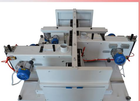
Impianto automatico per la lavorazione di strisce di lamiera con impianto elettrico separato, per la sbavatura dei bordi di pezzi con larghezza da 30 a 450 mm e spessore da 0,5 a 4 mm.
